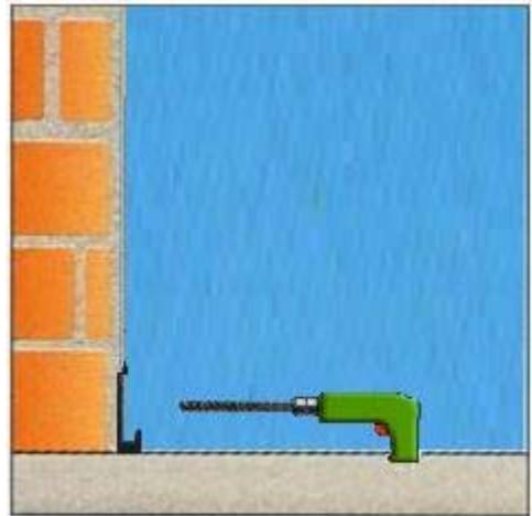
**Fig.2** Eseguire i due fori di diametro 6 mm e profondi 40 mm.
