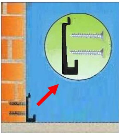
**Fig.3** Inserire i due fischer, prendere il gancio inserire le due viti negli appositi fori, avvitare le viti e il gancio sarà fisso al muro.
